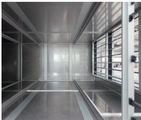
Воздушные клапаны. Они используются для регулирования количества воздуха и контроля давления на входе и выходе вентиляционных установок. Лопастные клапаны спроектированы так, чтобы обеспечить минимальную потерю давления в открытом положении. Когда Лопасты закрыты, они перекрываются и образуют герметичную конструкцию, препятствующую проходу воздуха. Он имеет высококачественный алюминиевый корпус и ударопрочные жесткие шестерни.
