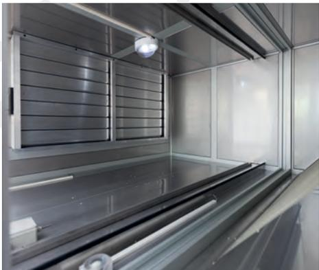
Корпуса внешние и внутренние стены изготовлены из оцинкованного листового металла, покрытого высококачественной электростатической порошковой краской, обладающей высокой прочностью и устойчивостью к неблагоприятным погодным условиям, а обе стены изолированы минеральной ватой толщиной 50 мм и плотностью 70 кг/м<sup>3</sup>. Для предотвращения утечки воздуха используются специально разработанные прокладки.
